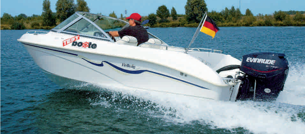
Das Testboot: Der Spiegel der 4,46 m langen Hellwig Taros trägt Langschafmotoren bis 75 PS.
